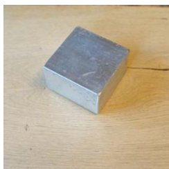
Прижать место дефекта охлаждающим блоком
