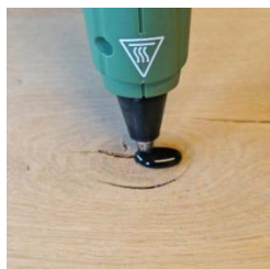
Заполнить дефект шпатлевкой
