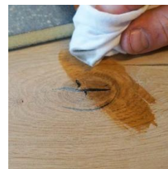
Финишная обработка дефекта
